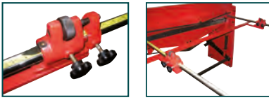
hinterer Anschlag mit Feineinstellung back side fence with vernier system
